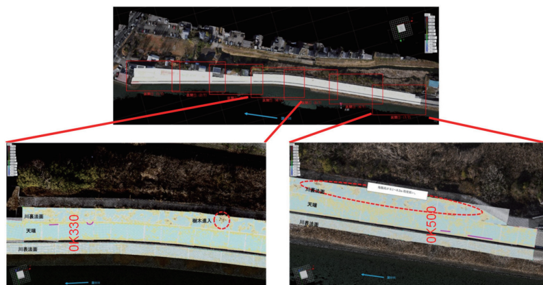
図7 地表面不陸測定状況 (区間③)
