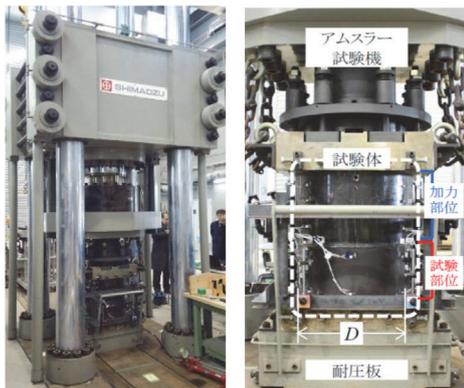
写真3.4 試験体と試験装置
