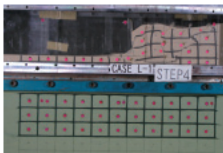
写真2.3 L型擁壁(Step4終了後)
