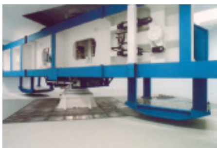
写真2.1 動的遠心載荷装置((独)土木研究所所有)
