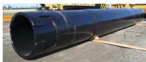
写真－4.5 3点支持式杭打ち機用のヤットコ
