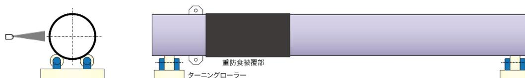
図 2.4.1 塗装設備概略図
