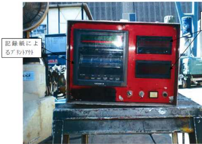
深度、電流値の計測装置の一例
