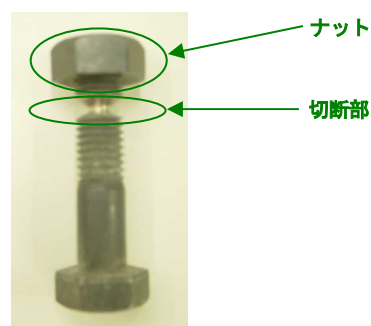
(シェアピン構造) Φ9mm のボルト せん断部 1～3mm
