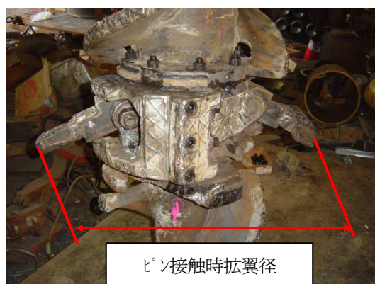
写真-F. 3. 5 ピン接触時の拡翼径の事前確認
