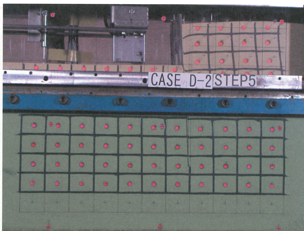
参考 写真 4.6 ケース D-2 (根入れ長 2.5/\beta 、 Dr61.6\% ) ステップ 5 波 (正弦波 30G 波) 加振後
