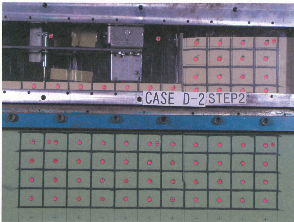
参考 写真 4.5 ケース D-2 (根入れ長 2.5/\beta 、 Dr61.6\% ) ステップ 2 波 (L2 相当) 加振後
