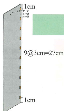
参考 図 6.2 ひずみゲージの添付間隔 参考 写真 6.3 アルミ板とひずみゲージ
