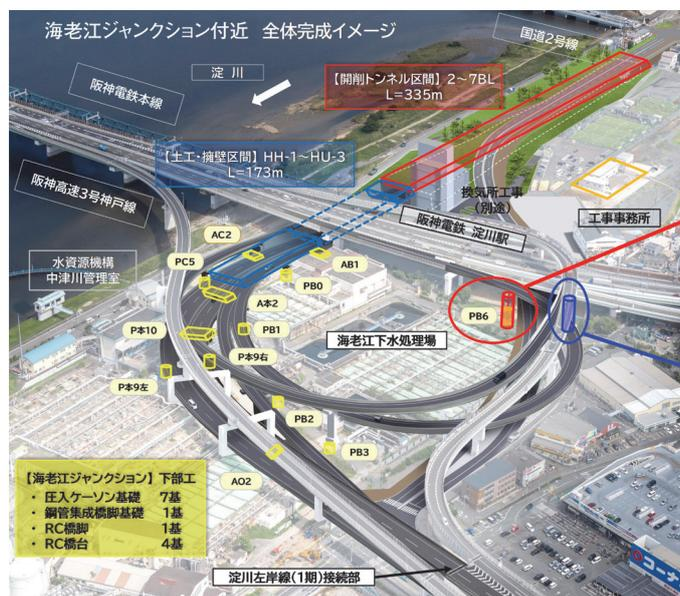
■海老江ジャンクション/イメージ図および、鋼管集成橋脚基礎(PB6)位置図
