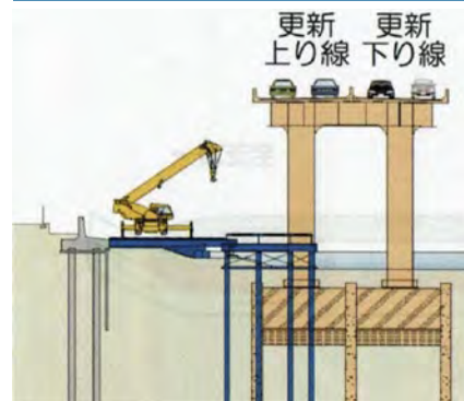
■ 更新線（上下線）を供用し、迂回路を撤去
