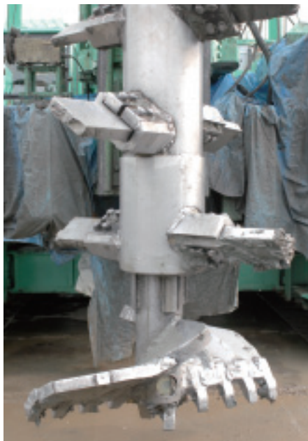
二軸正逆回転翼をもつ、掘削攪拌ヘッド
