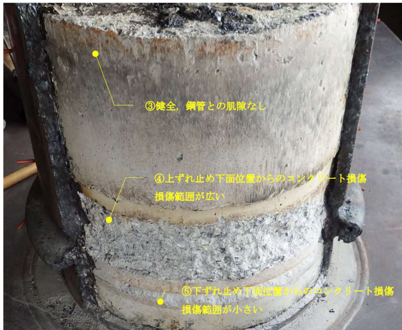
写真 2.9 解体後の試験体 (Case3：中詰めコンクリートの状況)
