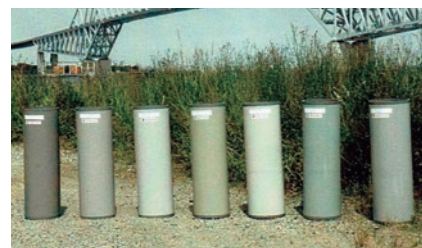
■現地にサンプルを持ち込み行われた重防食塗装のカラー検討※17
