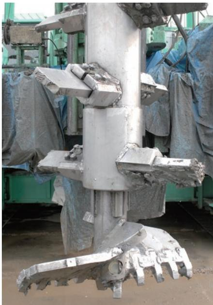
二軸正逆回転をもつ、掘削攪拌ヘッド
