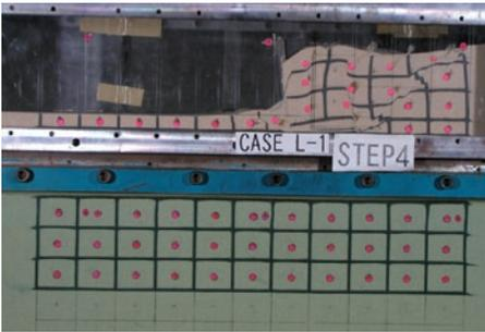
写真2.3 L型擁壁(Step4終了後)
