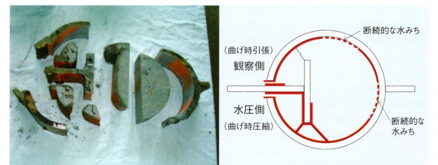
図-3.3 Case2 (P-T型継手) 水みち調査結果
