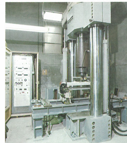
フラットプレートの加力試験中
