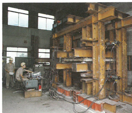
50トン疲労試験機：軽量で高強度なコンクリートの曲げ疲労写真
