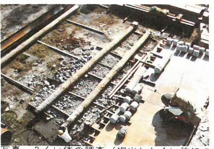
写真二 くい体の調査（掘出したくい体について、くい表面の粗滑度、くい径、くい断面の状況などを調査した。）
