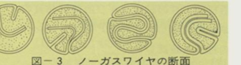
図-3 ノーガスワイヤの断面
