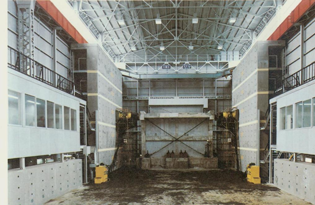
性などの実験が可能である。曲げモーメントで表わすと20,000t·mまでの載荷反力が期待できるとか。また、空調実験室の回転式空調実験装置も他に類を見ない設備として業界から注目を集めている。
