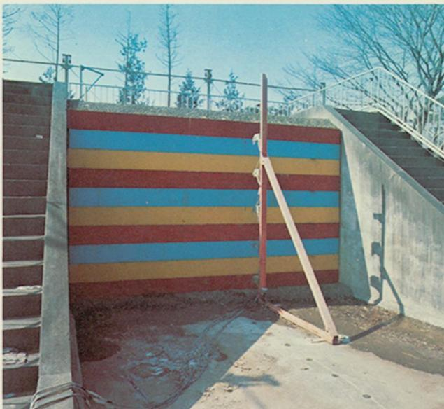
▲斜面崩壊実験槽
