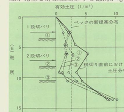
図-4 鉄筋コンクリート連続壁(t=600)において測定した根切りの進行にともなう土圧分布の推移 (文献-1参照)
