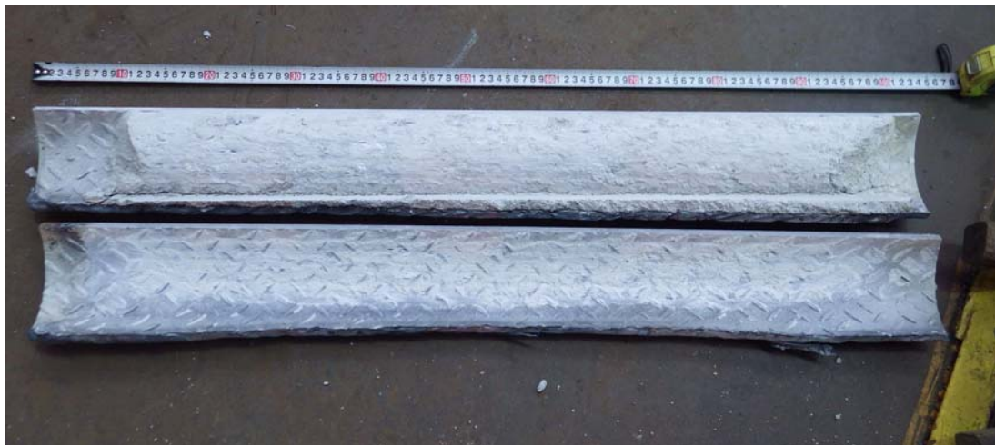
写真 2.5 B室のモルタルグラウトの状況
