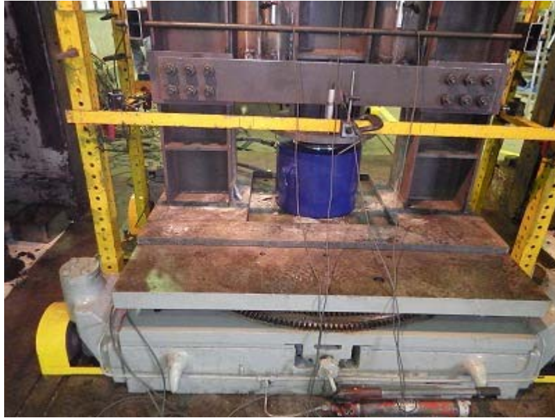
写真 2.2 1stSTEP 2 回目正側載荷終了後の状況
