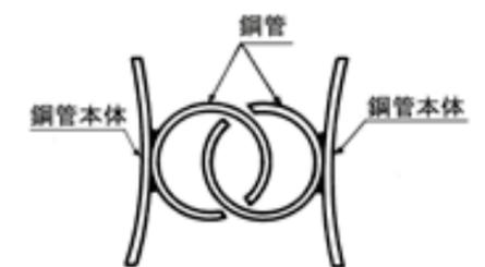
図2.2.16 JASPP-P型継手
