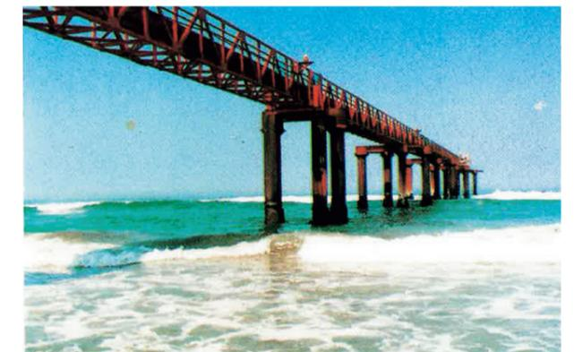
写真2.2.21 阿字ヶ浦沖における防食鋼管杭暴露状況<sup>53)</sup>
