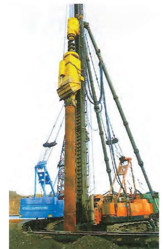
写真2.2.2 中掘り杭打ち機<sup>(1)</sup>
