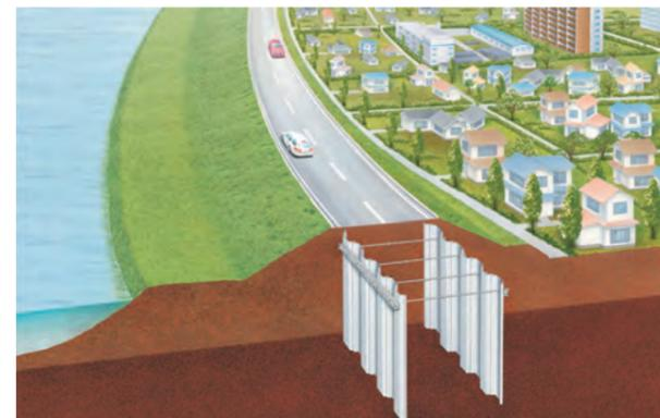
図2.5.7 鋼矢板芯壁堤の基本構造イメージ
