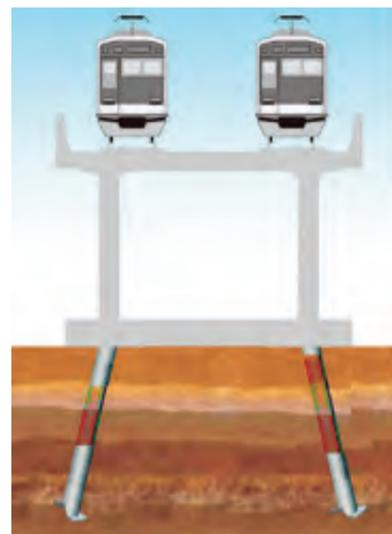
図2.6.8 鉄道構造物基礎の斜杭イメージ<sup>26)</sup>
