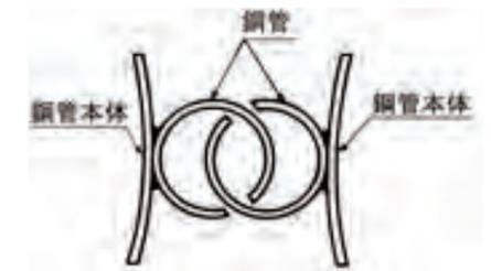
図2.2.16 JASPP-P型継手
