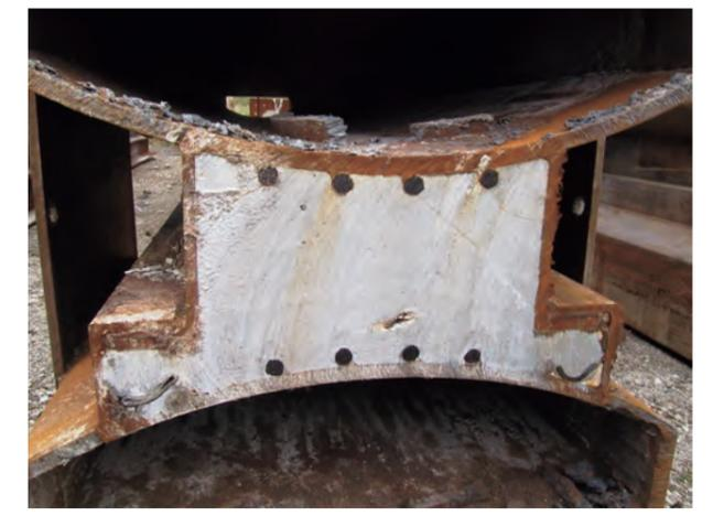
写真2.5.7 Super Junction<sup>16)</sup> (写真提供：鹿島建設)
