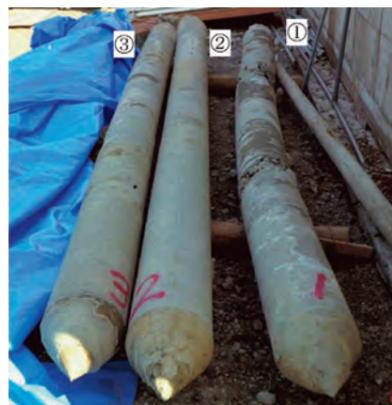
写真2.1.15 新潟市内の被災建物にて引き抜かれたRC杭<sup>66)</sup>
